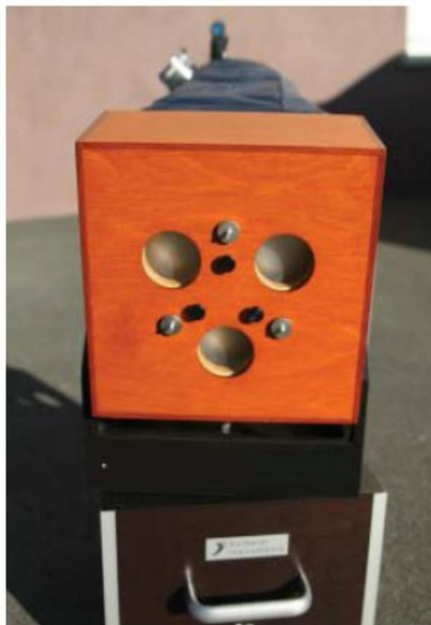
La cage est pensée pour ne pas avoir à démonter le miroir secondaire. Le primaire est quant à lui protégé par un carré de plexiglas. Il n'y a donc aucun moyen de rentrer en contact accidentellement avec la surface du miroir primaire.
